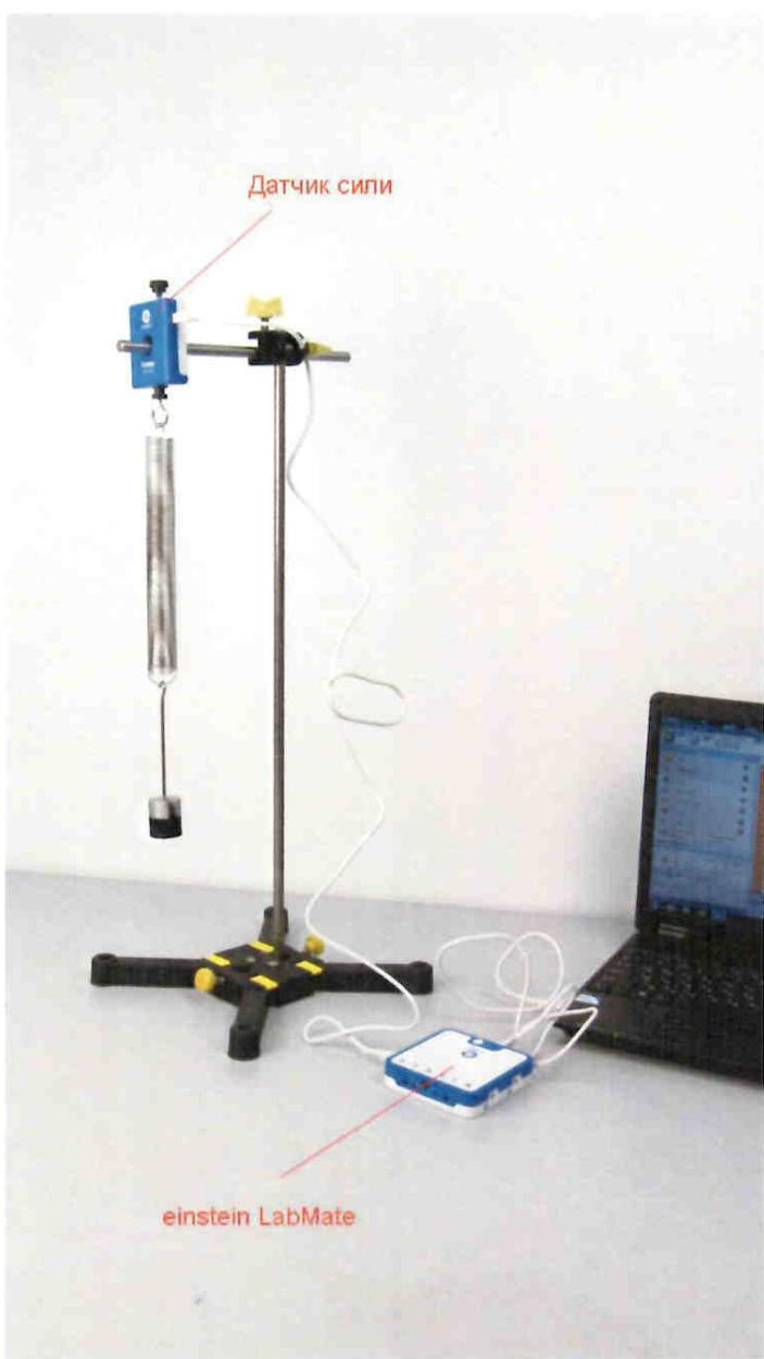
Мета роботи: визначити жорсткість пружини за частотою коливання вантажу, закріпленого на ній.
